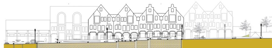
Ein weiteres Highlight bildet die Stampfbetonmauer, die farblich auf die Klinker abgestimmt wurde. Für eine optimale Ausleuchtung des Platz- und Straßenraums werden dezente Mastleuchten flankierend aufgestellt. Bodenstrahler inszenieren nachts die Bäume auf der Platzmitte als Hauptdarsteller des Platzes. Zusätzlich setzt eine Effektbeleuchtung entlang der Arkaden und im Bereich der „Bürgerbänke“ stimmungsvolle Akzente.
